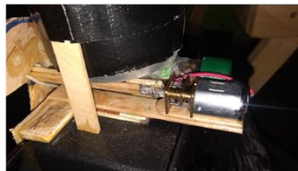
Gambar 3 Pemasangan Motor DC 12-N20
