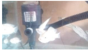
Gambar 8 Pengujian Pompa Air
