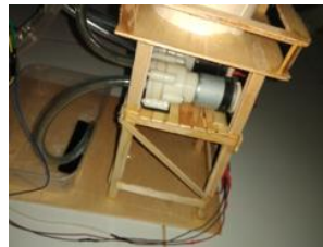
Gambar 11 Pengujian Pompa Air DC
