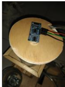
Gambar 4 Tampilan Sensor Sebagai Pendekteksi Air
