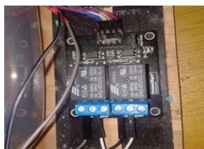
Gambar 6 Tampilan Relay Sebagai Saklar Elektrik
