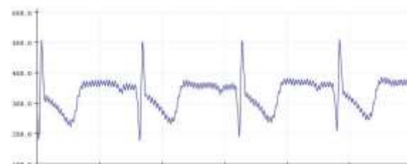
Gambar 9 Pengujian 5 AD8232 Subjek 1
