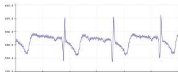
Gambar 8 Pengujian 4 AD8232 Subjek 1
