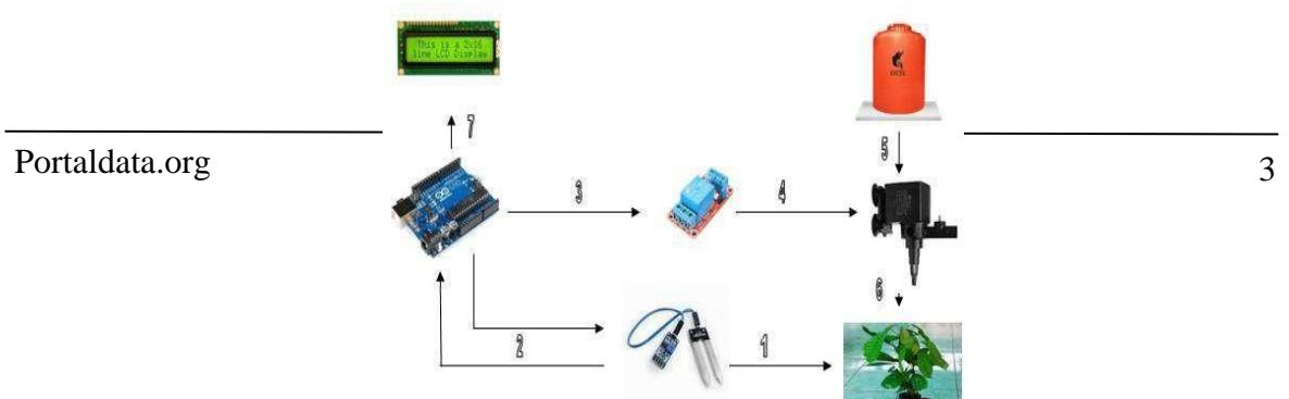
Gambar 1 : Rangkaian alat penyiraman.
