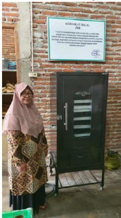
Gambar 2. Teknologi Pengering Rengginang menggunakan Tray Dryer
