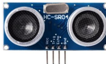
Gambar 2 Sensor Ultrasonik HC-SR04 (Kurniawan & Surahman, 2021)
