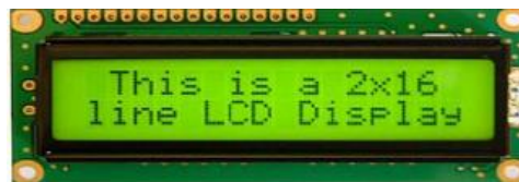
Gambar 3 LCD 16 x 2 (Selamet Samsugi, Mardiyansyah, et al., 2020)
